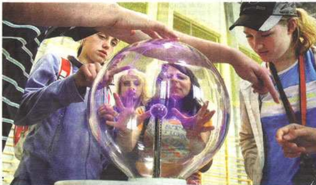
Uczniowie dotykają kuli wypełnionej mieszaną helu i argonu. Pole elektryczne wytwarza plazmę, czyli świecące nitki
